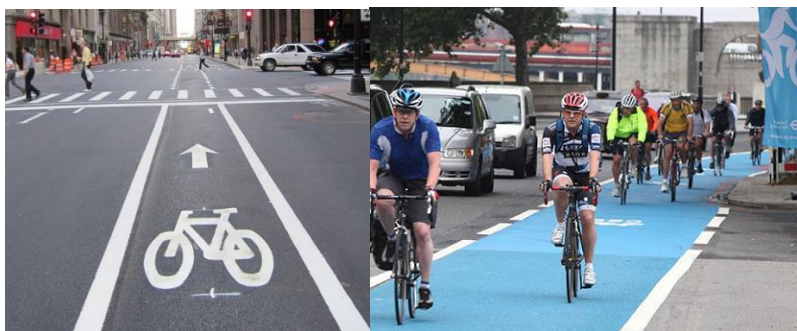
شکل ۲۱: تصاویر خط دوچرخه در خیابان. خط دوچرخه بخشی از خیابان است و صرفاً با خطوط یا رنگ مشخص می‌شود. تصویر راست: خط دوچرخه با رنگ مشخص شده است. تصویر چپ: خط دوچرخه با دو خط موازی و علامت دوچرخه در بین آن مشخص شده است.
